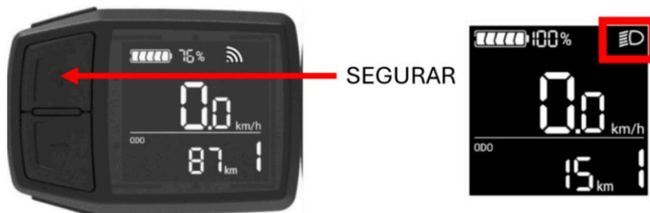
Sua E-Bike vem equipada de fábrica com farol dianteiro e lanterna traseira com funções de luz alta e baixa e buzina. Todas essas funções são controladas por um interruptor de controle com as seguintes indicações:
