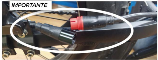
Desconecte o conector do motor da sua bicicleta antes de retirar a roda.
