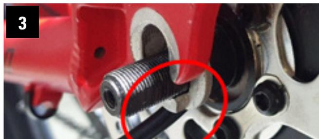
Ao instalar novamente a roda, certifique-se de que o cabo que sai do motor esteja voltado para baixo, conforme mostra a foto.
