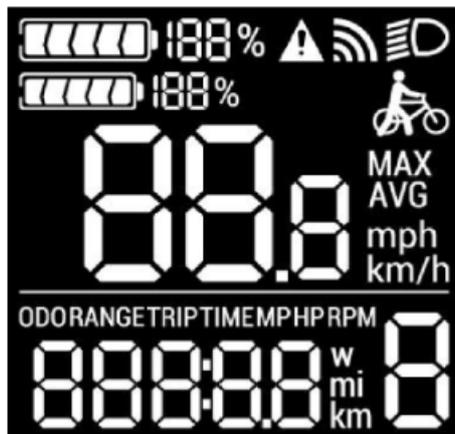
Após ligado, o painel se acenderá, indicando o nível de bateria e a assistência do motor da bicicleta, conforme a imagem abaixo.
